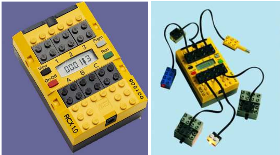
FIGUR 5.6: LEGOs RCX med og uden sensorer og aktuatorer
