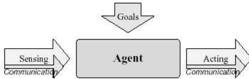
FIGUR 4.4: Skematisk fremstilling af en kommunikerende agent. Illustrationen er lånt fra [49]
