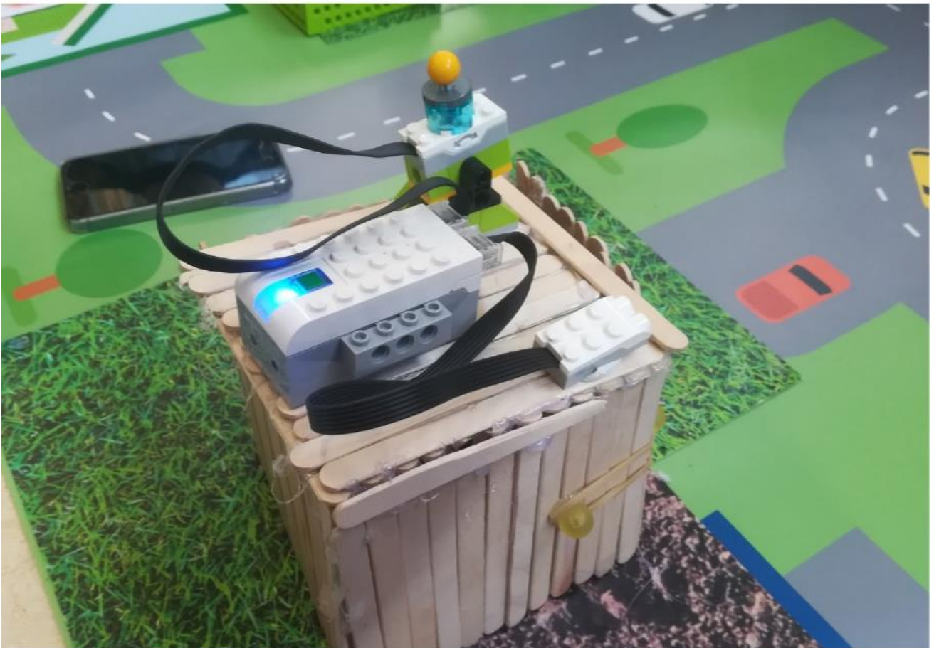
Billede 37. Alarmsystemet med to funktioner: En vippefunktion til dyrepasseren samt en bevægelsessensor til at opdage tyven.
